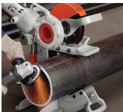
Tagliatubo 258 con supporto a rulli da usare per la smussatura. Si consiglia di far svolgere questa operazione a due operatori
