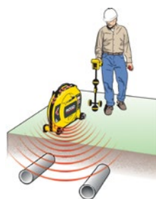
Segnale ad induzione per localizzare i servizi.
